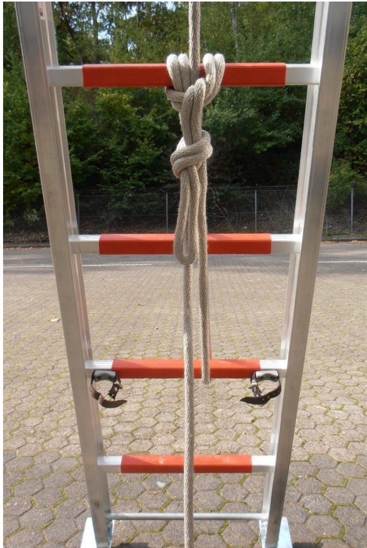
Abbildung 24: Sichern des Zugseils mit Mastwurf und Spierenstich
