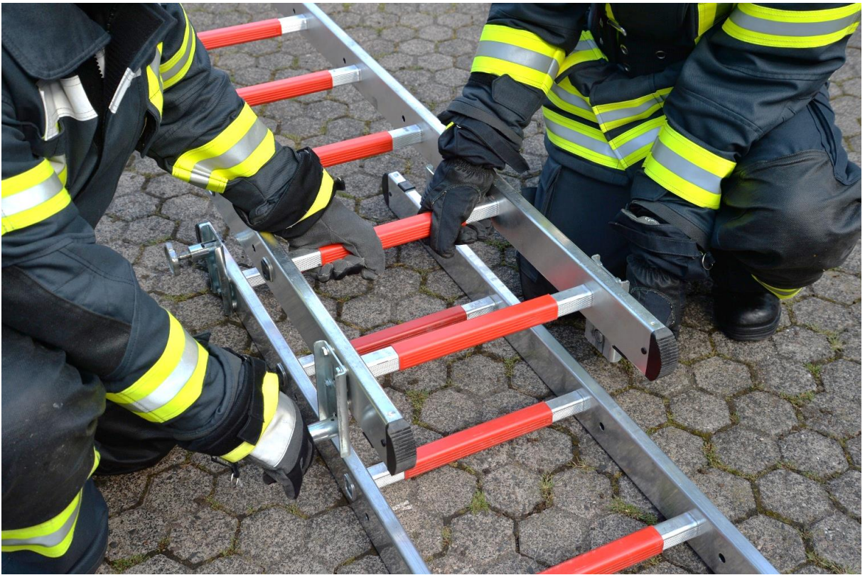
Abbildung 40: Ausrichten der Federbolzen
